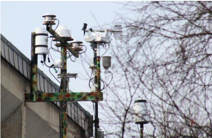
Instruments de mesure des rayonnements UV et, à droite, des paramètres météorologiques.
